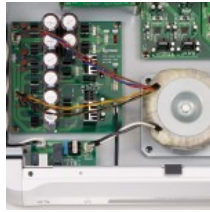
環型變壓器與供電線路
